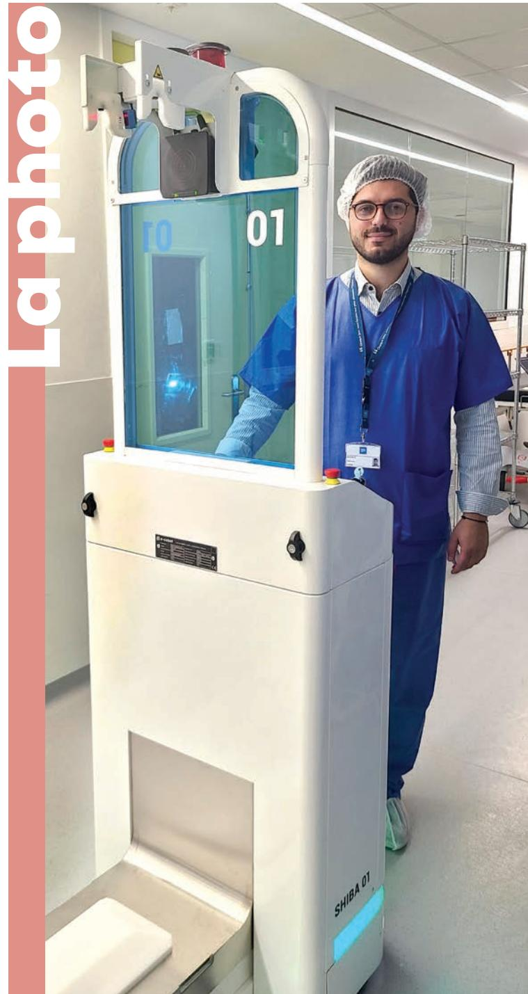
Jurgen Hasani, responsable de la plateforme logistique Géolab, avec le robot du fabricant nantais E-Cobot. Cette solution robotique autonome, optimisée en collaboration avec Station H, récupère les ancillaires (boîtes contenant les instruments de chirurgie) au magasin situé au rez-de-chaussée, pour les apporter jusqu'à l'entrée des salles de bloc opératoire.
