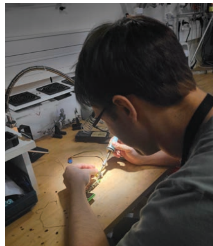
Julien Deléaval, technicien biomédical répare un maintien-seringue d'un module DPS évitant le changement de l'intégralité du pousse-seringue
